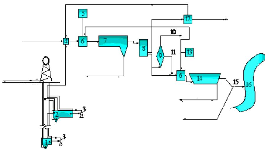
1- шахтный зумпф; 2 - резервуар-накопитель; 3 - насосная станция главного водоотлива; 4 - приемная камера; 5 - реагентное хозяйство; 6 - смеситель; 7 - отстойник; 8 - фильтр; 9 - установки снижения минерализации; 10 - рассол; 11 - трубопровод деминерализованной воды; 12 - сооружения повторного использования воды; 13 - хлораторная; 14 - пруды доочистки; 15 - сброс очищенной шахтной воды; 16 - водный объект.
