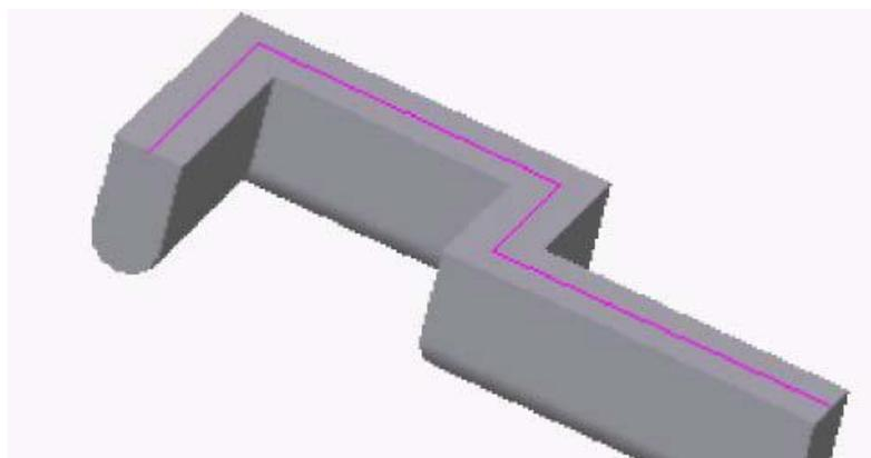
Рисунок 5.33 - Формирование модели по заданной траектории с использованием булевой операции Пересечение элементов
