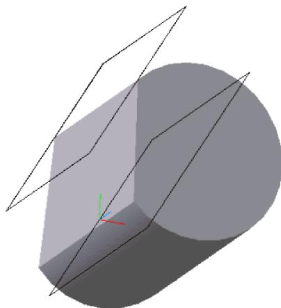
Рисунок 6.14. - Вспомогательная плоскость проходящая через ребро и параллельная
