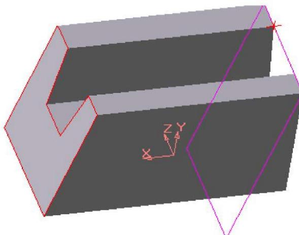
Рисунок 6.9. - Вспомогательная плоскость через вершину параллельно боковой грани
