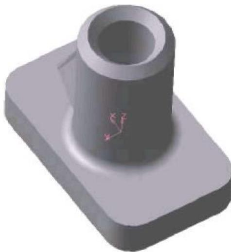
Рисунок 7.3 - Модель с выполненными скруглениями
