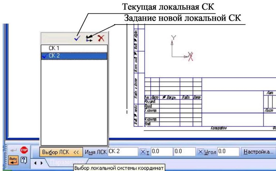
Рисунок 3.1 - Содержание Панели свойств при создании локальной системы координат
