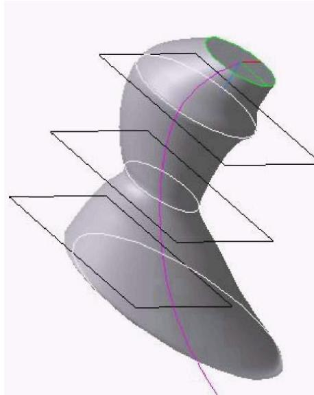
Рисунок 5.18 - Модель тела с криволинейной направляющей
