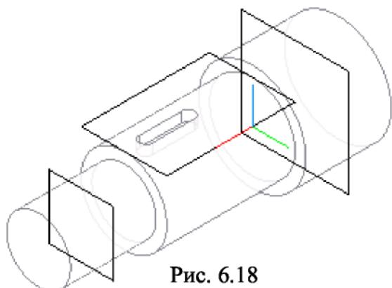
5. Для отверстий выполняются эскизы с учетом последующей операции - операции вращения. Размеры и форму эскиза задать, используя чертеж детали (рис. 6.15).
