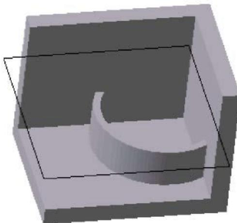
б) модель с выполненным ребром жесткости
