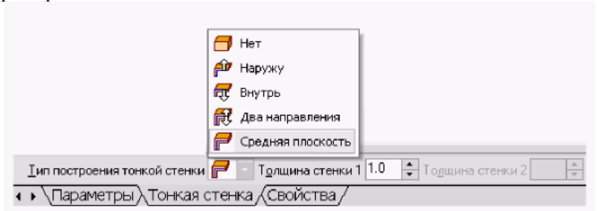
Рисунок 5.10. - Способы задания толщины стенки
