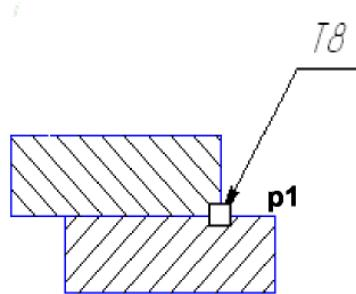
Рисунок 3.19 - Выполнение обозначения с использованием кнопки Линии выноски.
