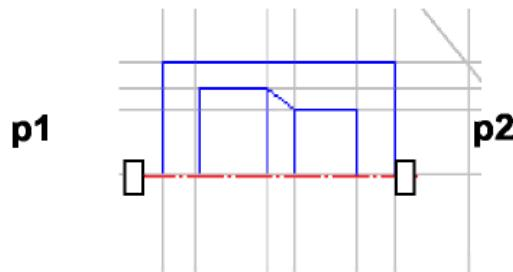
Рисунок 1.22. - Построение симметричного изображения
