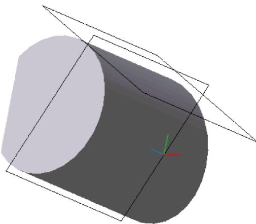
Рисунок 6.12 - Вспомогательная плоскость, касающаяся цилиндрической поверхности вращения
