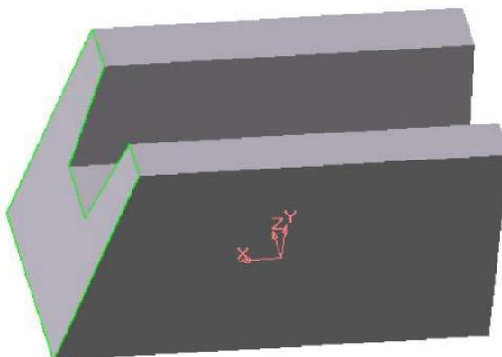
Рисунок 7.9. - Модель с выполненным уклоном боковой грани относительно основания
