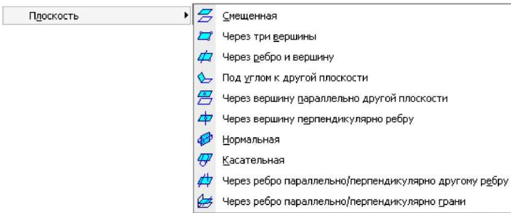
Рисунок 6.3. - Команды, предназначенные для создания вспомогательных плоскостей
