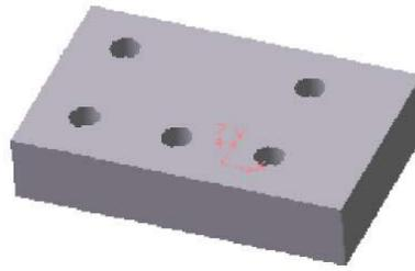
Рисунок 7.16. - Модель с выполненным массивом отверстий и последующим удалением части из них
