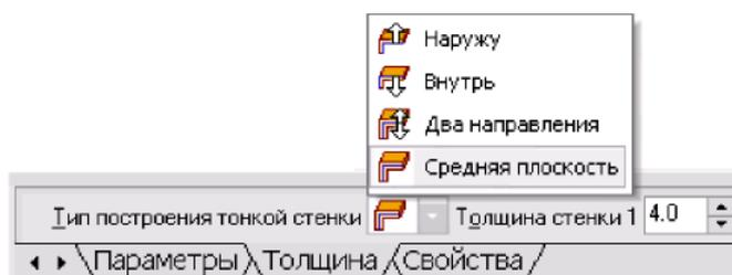
Рисунок 7.7. - Задание параметров на вкладке Толщина
