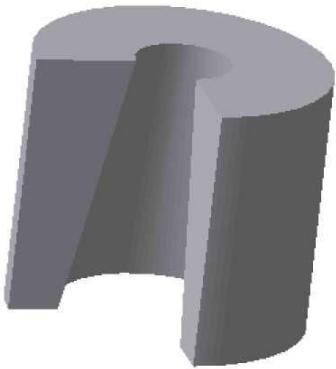
Рисунок 7.12. - Результат отсечения части модели по эскизу
