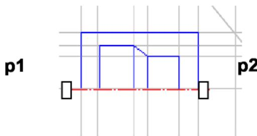
Рисунок 1.22. - Построение симметричного изображения
