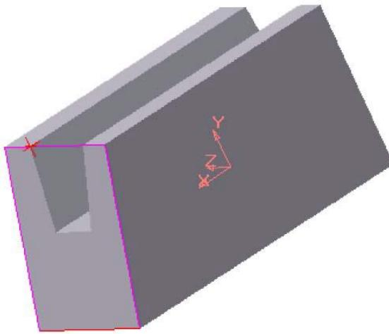
Рисунок 6.7. - Вспомогательная плоскость через ребро и вершину
