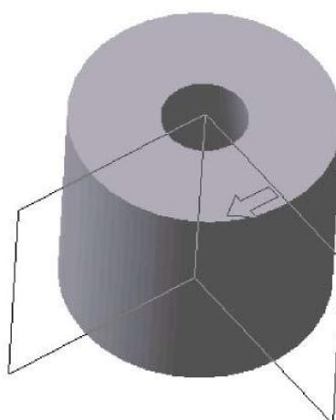
Рисунок 7.11. - Модель тела и проецирующей поверхности, заданной эскизом
