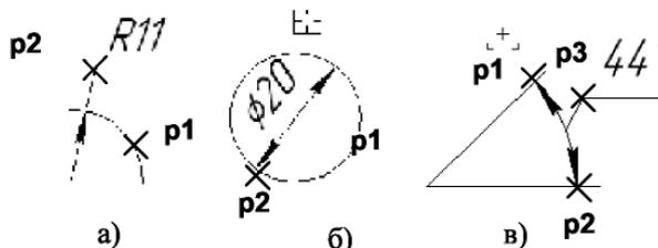
Рисунок 2.10 - Нанесение размеров дуги, диаметра окружности и углового размера
