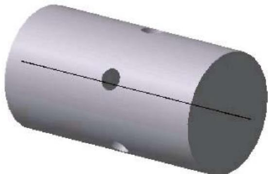
Рисунок 7.23. - Модель цилиндра с выполненным в нем массивом углублений по концентрической сетке
