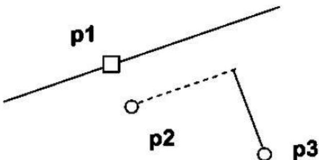
Рисунок 1.10 - Построение отрезка, перпендикулярного заданной прямой
