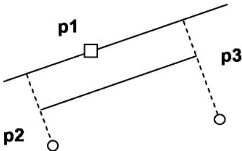
Рисунок 1.9. - Построение отрезка, параллельного заданной прямой
