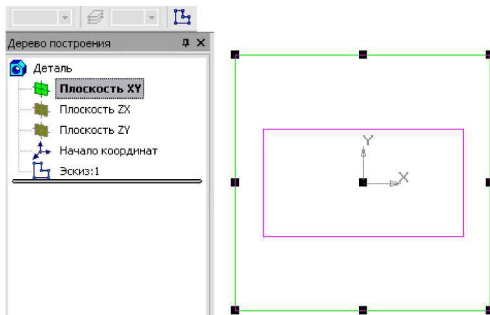
Рисунок 5.6 - Создание эскиза на координатной плоскости
