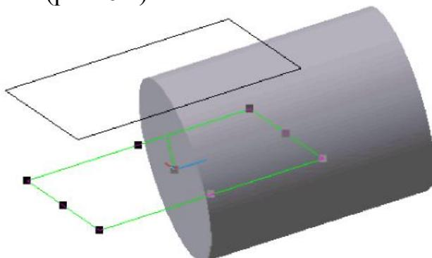
Рисунок 6.5. - Вспомогательная плоскость смещенная относительно координатной плоскости ХОZ
