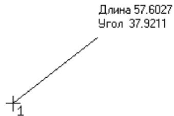
Рисунок 1.18. - Построение отрезка по его длине и углу наклона
