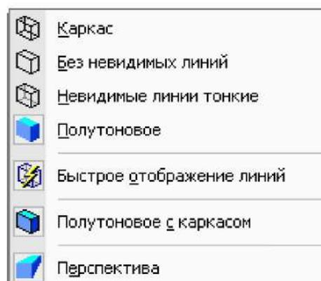
Рисунок 5.4 - Способы отображения модели на экране
