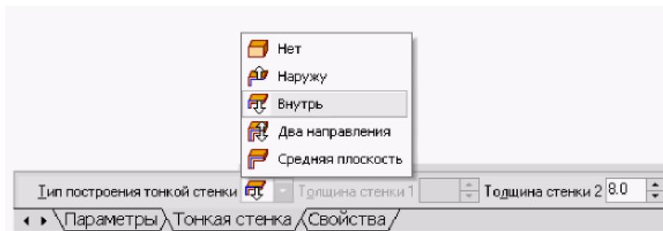
Рисунок 5.29 - Окно для задания параметров тонкой стенки
