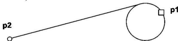
Рисунок 1.11. - Построение отрезка, касательного к окружности
