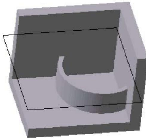
б) модель с выполненным ребром жесткости
