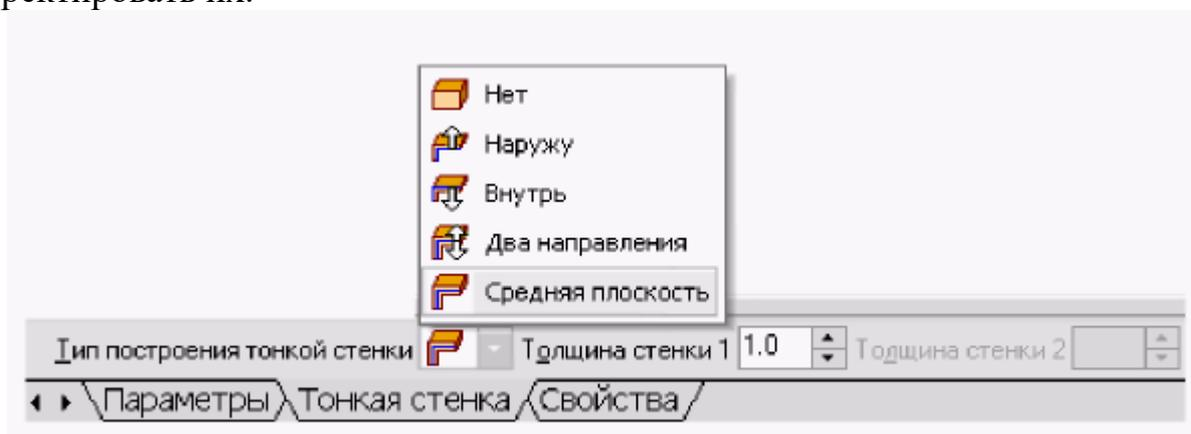
Рисунок 5.10. - Способы задания толщины стенки
