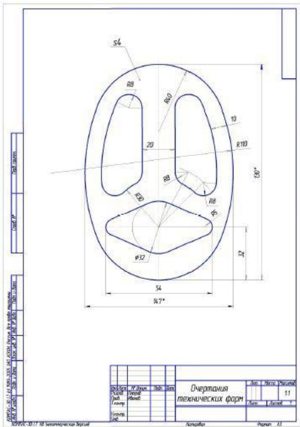
Рисунок 2.13 - Пример выполнения работы «Очертание технических форм»
