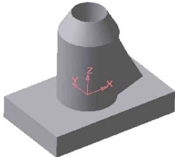
Рисунок 7.2 - Модель с выполненной фаской на цилиндре
