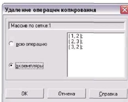
Рисунок 7.15. - Окно диалога по удалению части элементов массива
