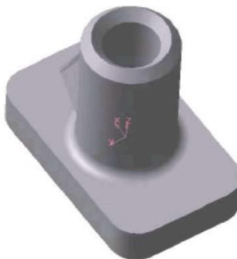
Рисунок 7.3 - Модель с выполненными скруглениями
