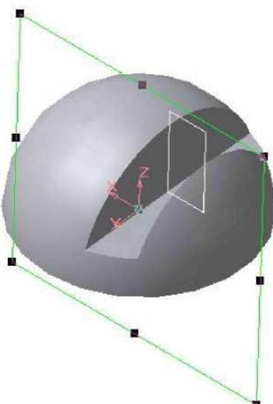
Рисунок 5.30 - Модель половины шара со сквозным вырезом
