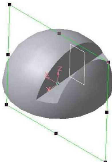
Рисунок 5.30 - Модель половины шара со сквозным вырезом
