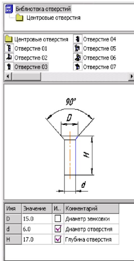
Рисунок 7.4. - Панель Выбора отверстий и их параметров
