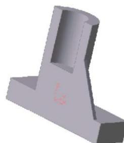
Рисунок 7.10. - Модель тела, полученная после отсечения исходной модели ее плоскостью симметрии
