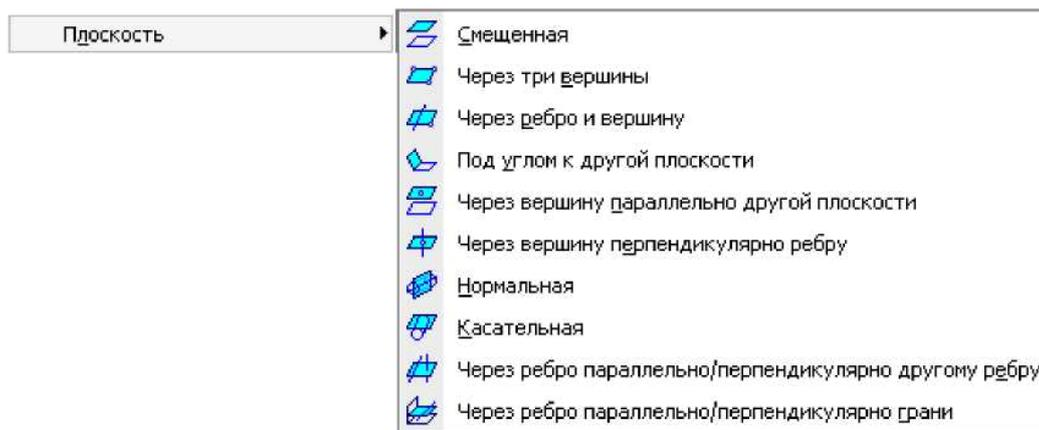
Рисунок 6.3. - Команды, предназначенные для создания вспомогательных плоскостей
