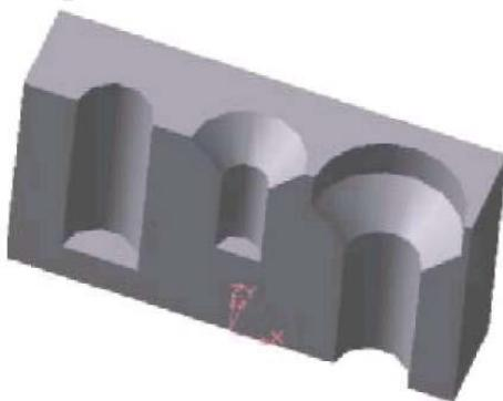
Рисунок 7.5 - Модель детали с отверстиями, конфигурация и размеры которых взяты из библиотеки
