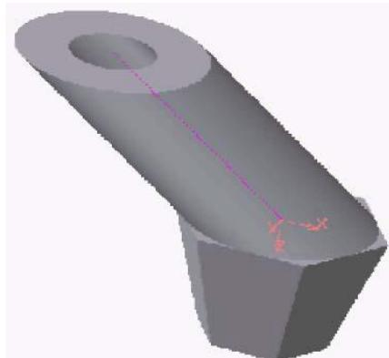
Рисунок 5.28 - Модель детали с приклеенным тонкостенным цилиндром
