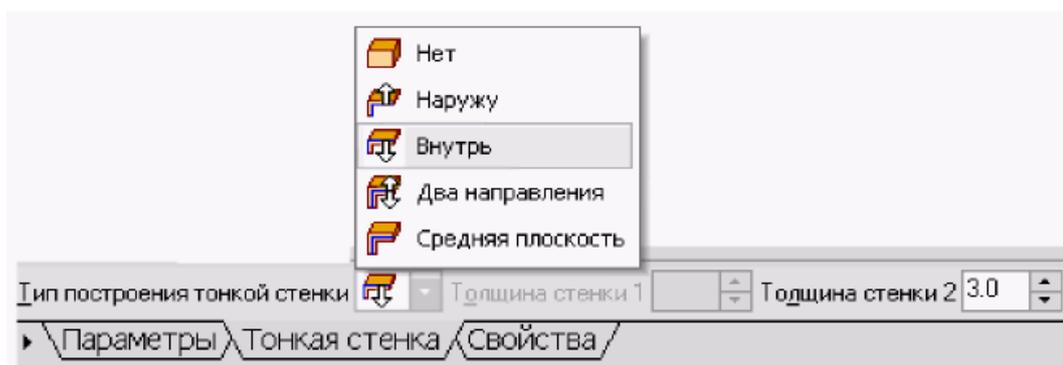
Рисунок 5.22 - Вкладка Тонкая стенка для задания параметров тонкой стенки
