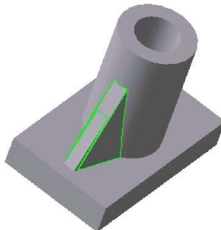
Рисунок 7.8. - Модель с ребром жесткости выполненным с уклоном
