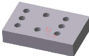
Рисунок 7.18. Модель тела после создания массива отверстий
