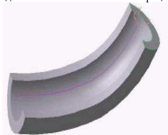
Рисунок 5.15 - Модель тела, образованного кинематической операцией
