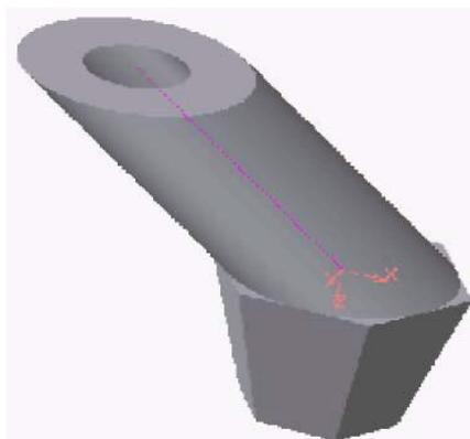
Рисунок 5.28 - Модель детали с приклеенным тонкостенным цилиндром
