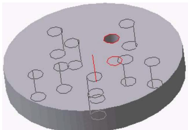
Рисунок 7.19. - Фантом массива отверстий по концентрической сетке
