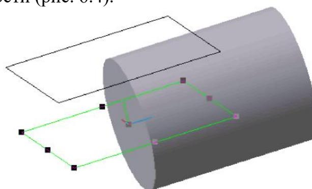
Рисунок 6.5. - Вспомогательная плоскость смещенная относительно координатной плоскости XOZ
