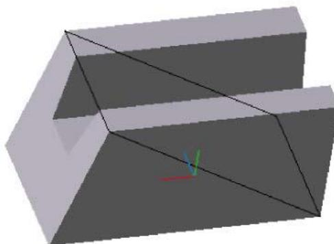
Рисунок 6.6. - Вспомогательная плоскость через три вершины
