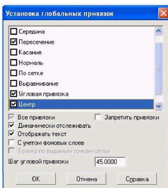
Рисунок 3.4 - Включение команды Установка глобальных привязок
