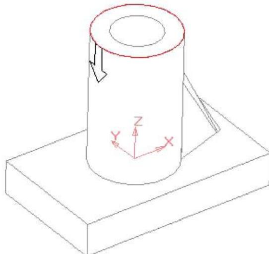
Рисунок 7.1 - Модель на этапе формирования фаски на цилиндре
