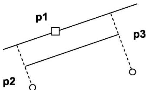
Рисунок 1.9. - Построение отрезка, параллельного заданной прямой
