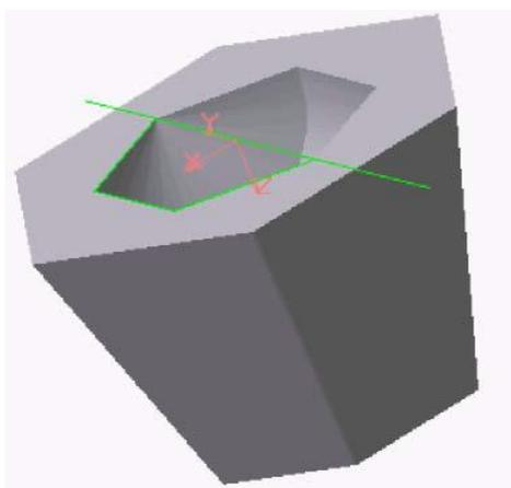
Рисунок 5.31 - Модель усеченной пирамиды с углублением, образованным с применением команды Вырезать вращением
