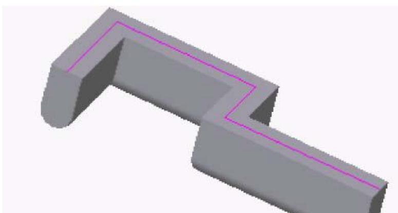
Рисунок 5.33 - Формирование модели по заданной траектории с использованием булевой операции Пересечение элементов
