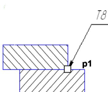
Рисунок 3.19 - Выполнение обозначения с использованием кнопки Линии выноски.
