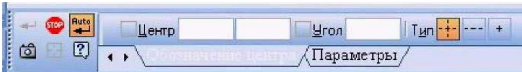
Рисунок 3.21 - Панель свойств после нажатия кнопки Обозначение центра
