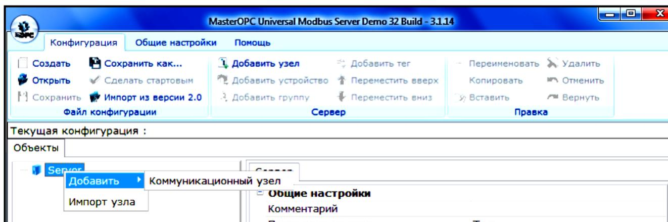
Рисунок 1. Добавление коммуникационного узла
