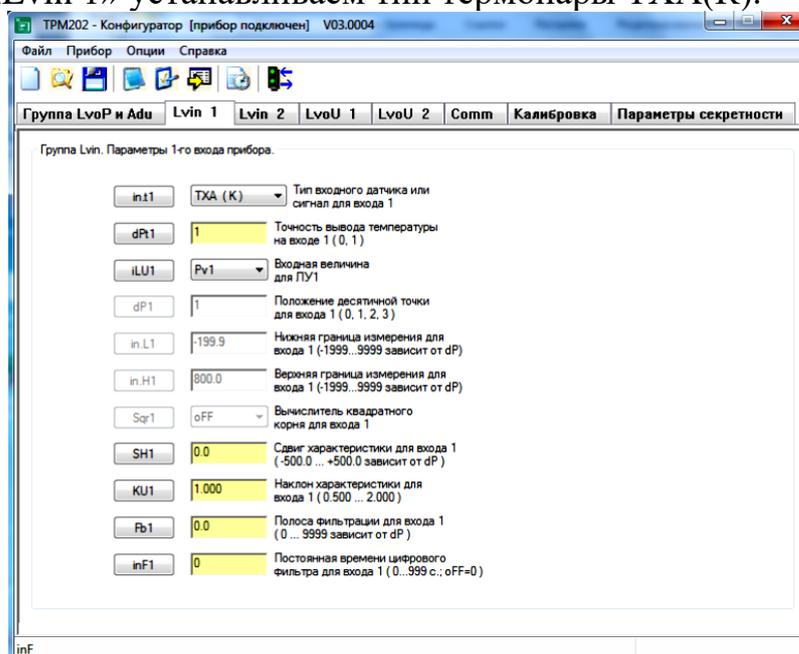
Как правило, все приведенные в конфигураторе опции интуитивно понятны и подробно описаны в документации к приборам либо на сайтах фирм изготовителей. Вследствие большого разнообразия устройств нет возможности произвести описание каждого устройства. Вместе с тем, следует отметить возможности выбора в конфигураторе вида входного сигнала, типа датчика,
