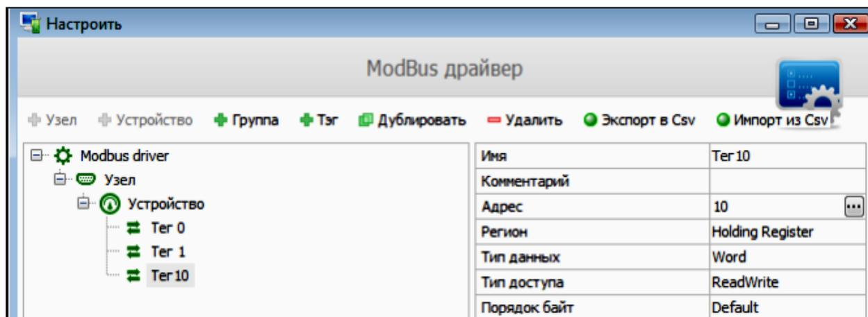
Рисунок 8. Пример настройки тега устройства
