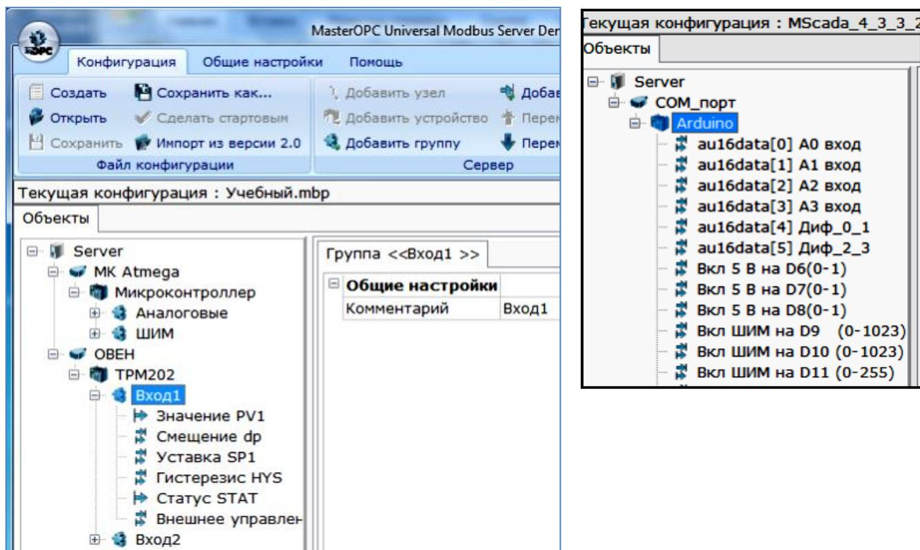
Рисунок 5. Установка тегов в устройство
