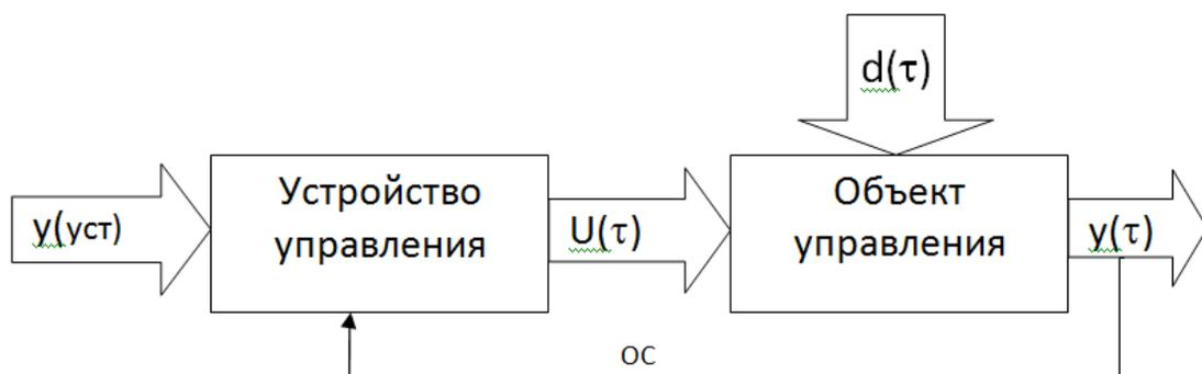
Рисунок 4. Схема управления по отклонению с отрицательной обратной связью
