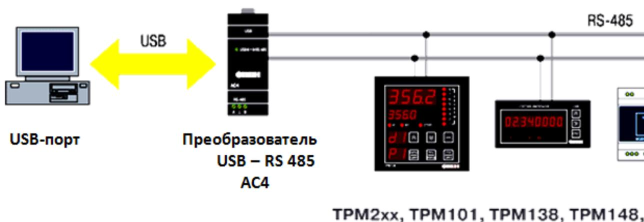
Рисунок 1. Схема подключение контрольно-измерительных и управляющих приборов для работы с SCADA системой
