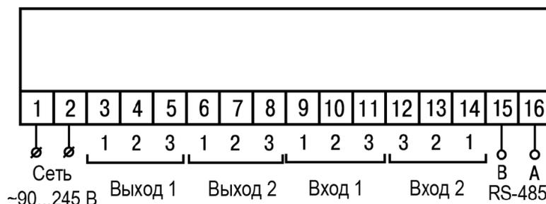
Рисунок 3. Схема контактов тыловой части измерителя-регулятора ОВЕН ТРМ202
