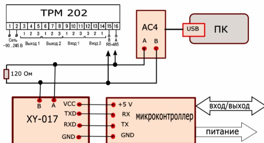
Рисунок 2. Схема подключения приборов к компьютеру по линии RS485.
