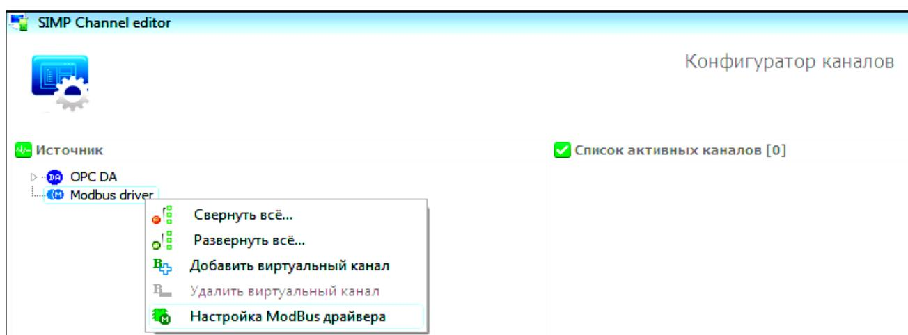
Рисунок 3. Переход в режим настройки Modbus drive
