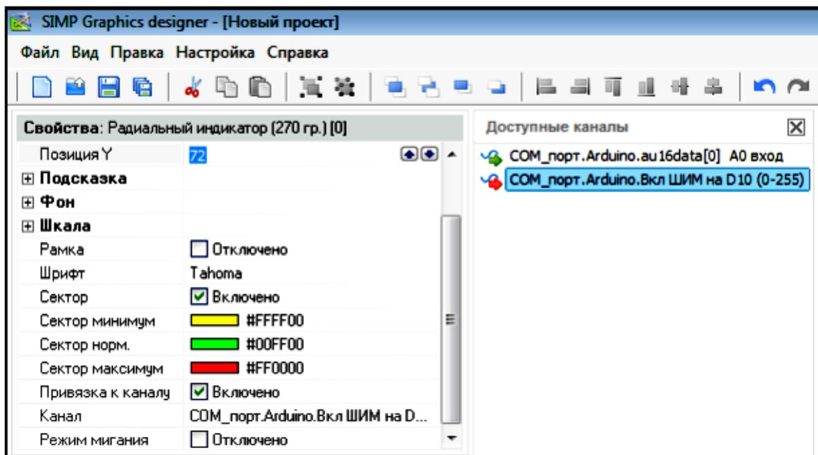
Рисунок 13. Вид фрагмента редактора мнемосхемы при привязке активного канала к элементу мнемосхемы
