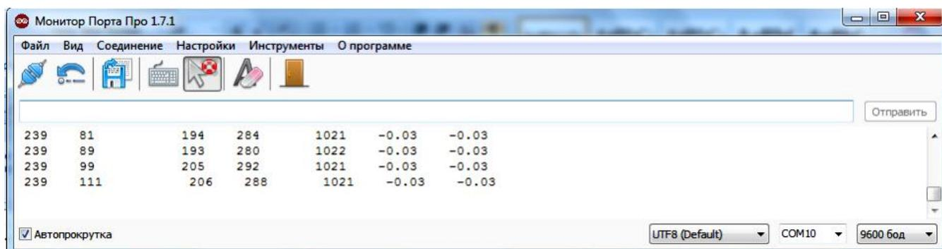
4. Установить соединение через опцию «Соединение». На экране появятся значения показаний датчика примесей (A0 – первая колонка) и электрического потенциала на солнечной батарее (A1- вторая колонка)
