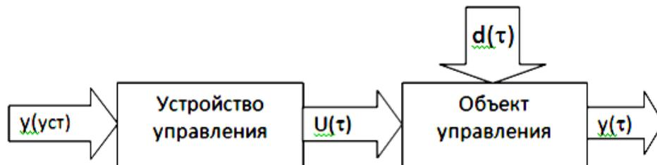
Рисунок 2. Схема управления по задающему воздействию.
