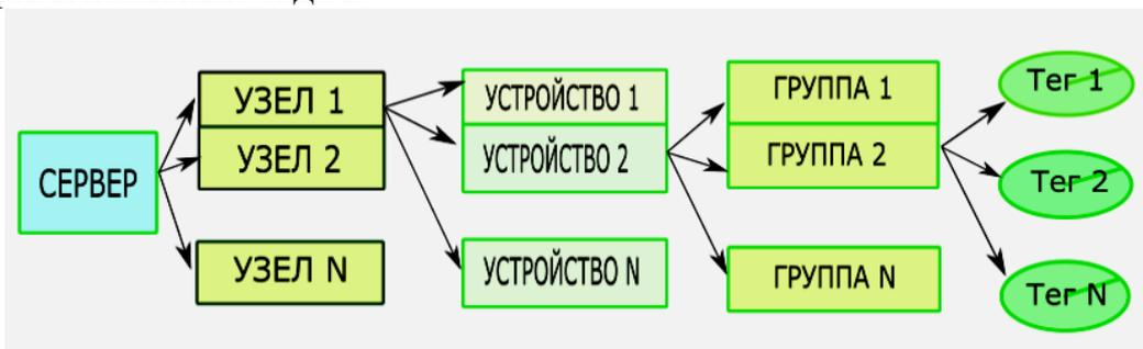
Рисунок 2. Структура дерева объектов интерфейса OPC сервера
