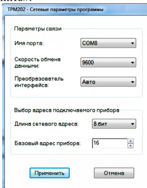
Номер порта определяется в диспетчере устройств. Однако скорость обмена данными и базовый адрес прибора необходимо взять из документации в разделе заводских настроек. Если такие данные (обычно после эксплуатации прибора с изменением заводских установок) отсутствуют, то можно войти в конфигуратор под опциями типа «прибор отключен», «работать offline» и др. Затем в конфигураторе в соответствующих пунктах меню определить сетевые параметры.
