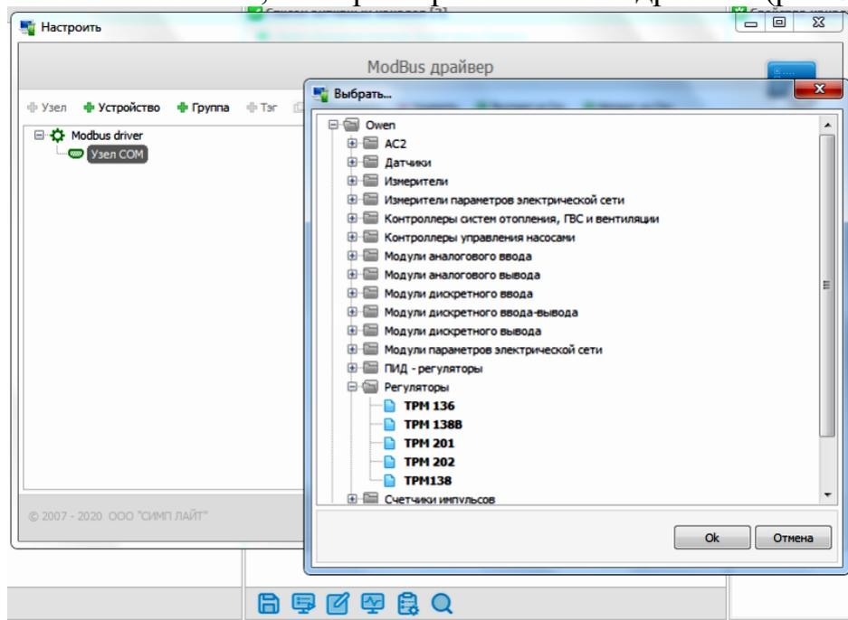
Рисунок 6. Добавление устройства из опции «Выбрать из шаблона»
