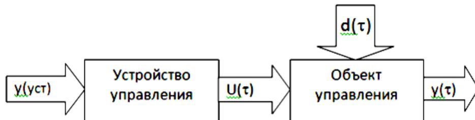
Рисунок 2. Схема управления по задающему воздействию.
