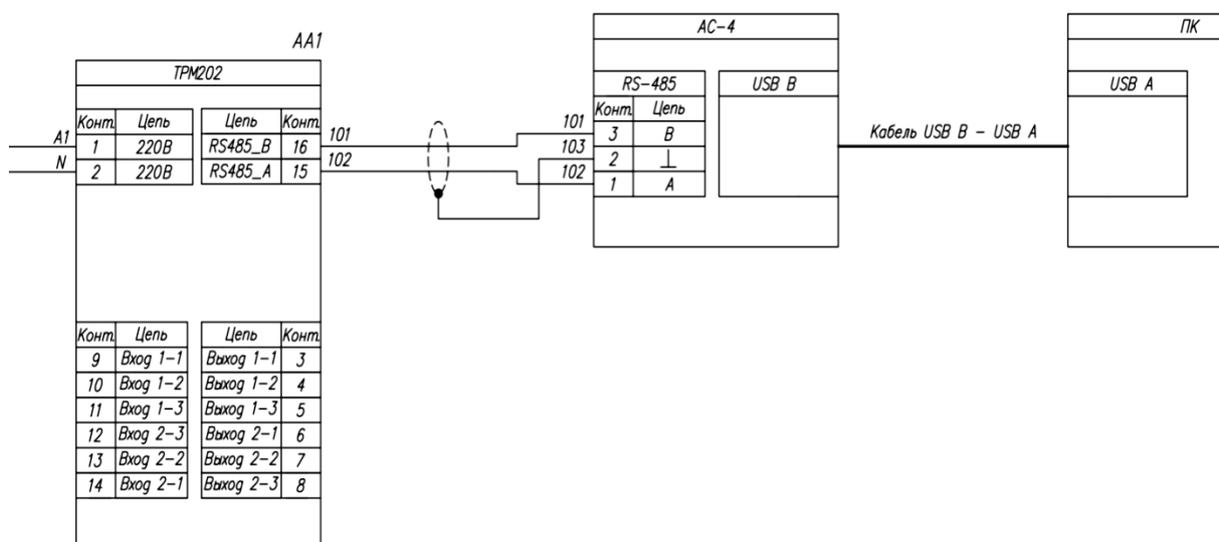
Рисунок 5. Схема подключения измерителя-регулятора TPM202 и преобразователя интерфейса А4 к компьютеру.
