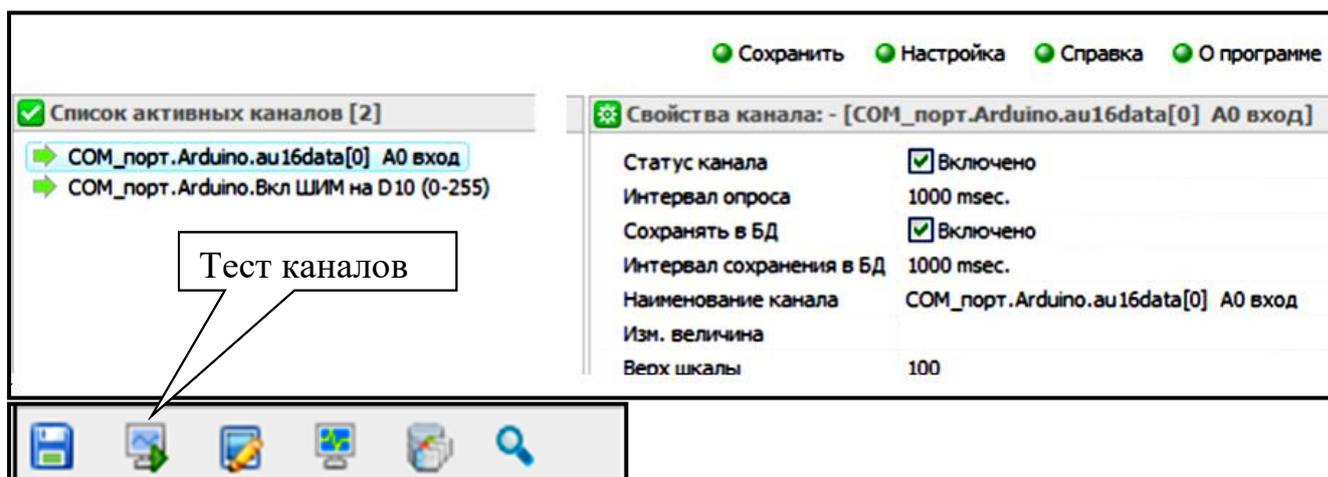
4. Для проверки соединения с прибором запускаем «Тест каналов» кнопкой, находящейся внизу окна «Список активных каналов». В появившемся новом окне через некоторое время должна появиться информация с прибора. Если такой информации нет, то следует проверить правильность согласования установки COM порта в OPC сервере и диспетчере устройств.
