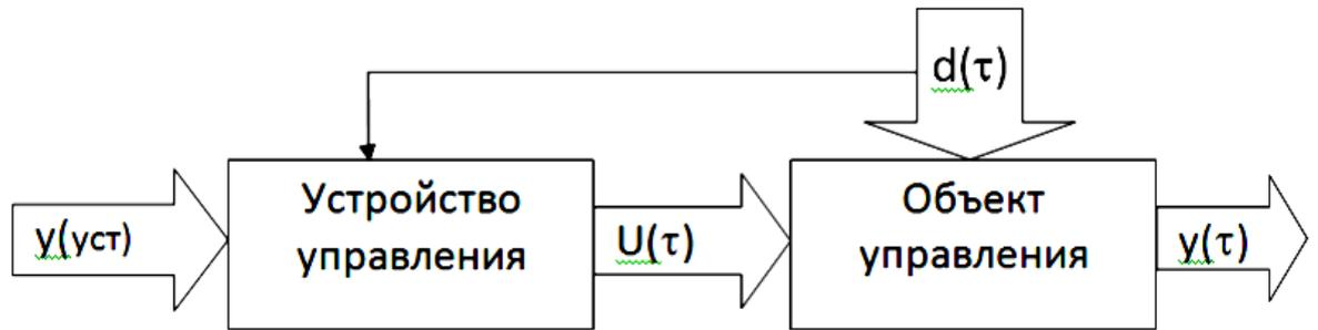
Рисунок 3. Схема управления по возмущающему воздействию
