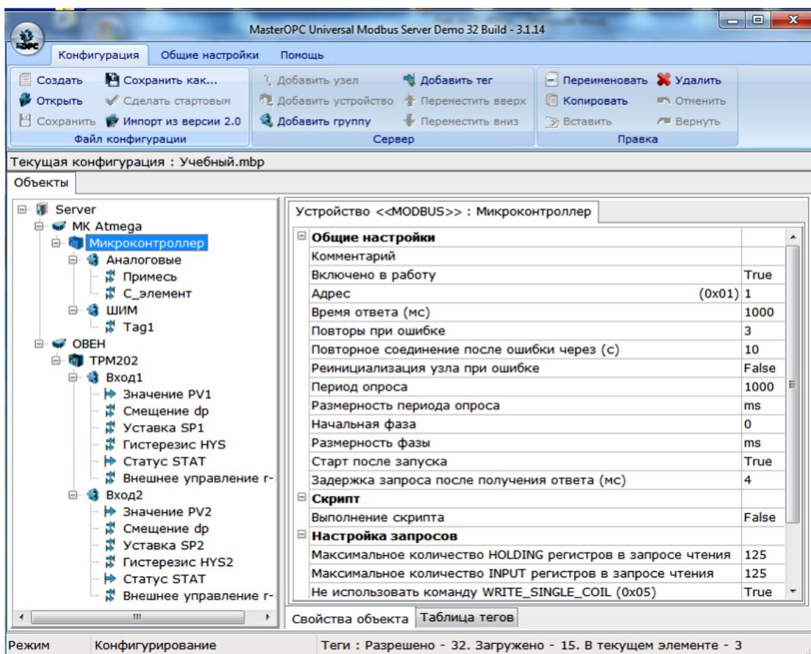
Рисунок 4. Примерный вид окна *MasterOPC Universal Modbus Server* после создания дерева объектов.
