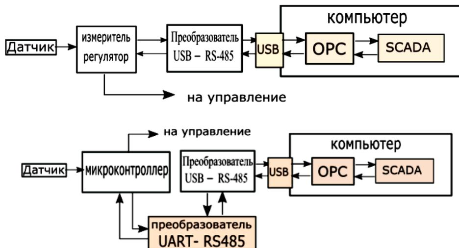
Рисунок 1. Схемы сопряжения физического уровня с программным обеспечением
