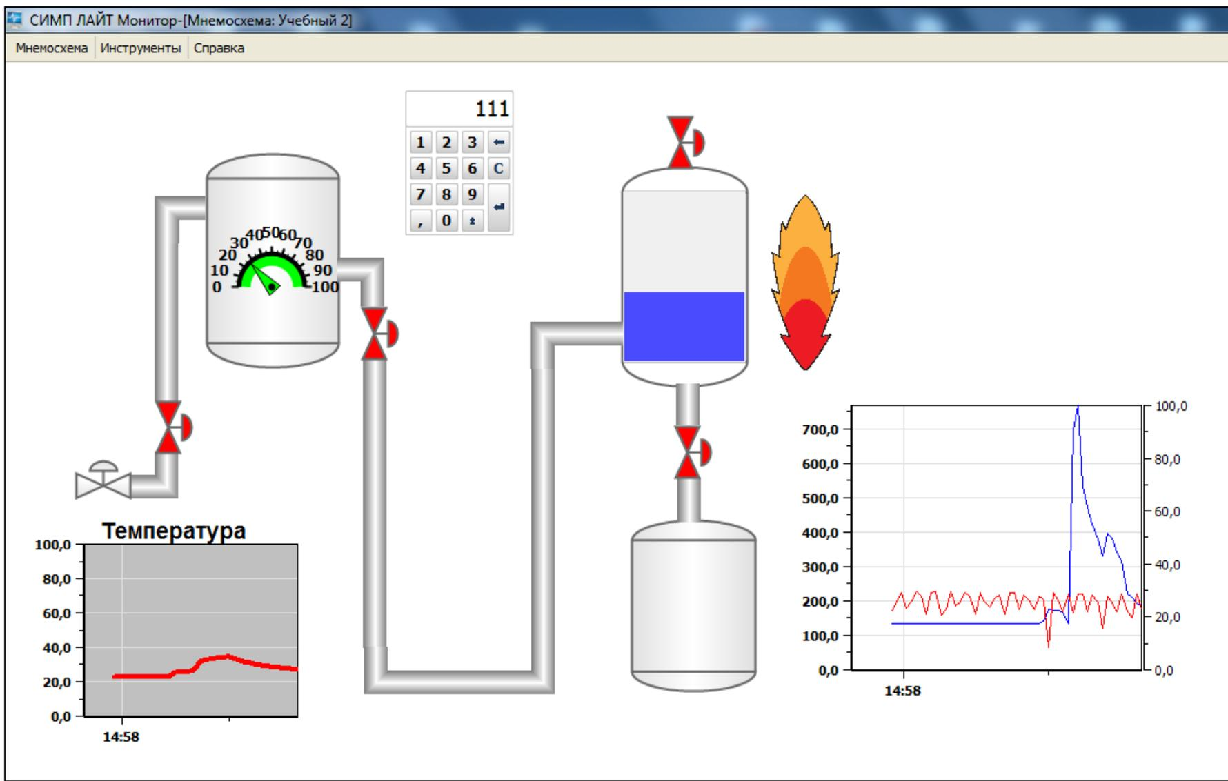
Рисунок 16. Вид мнемосхемы в рабочем состоянии
