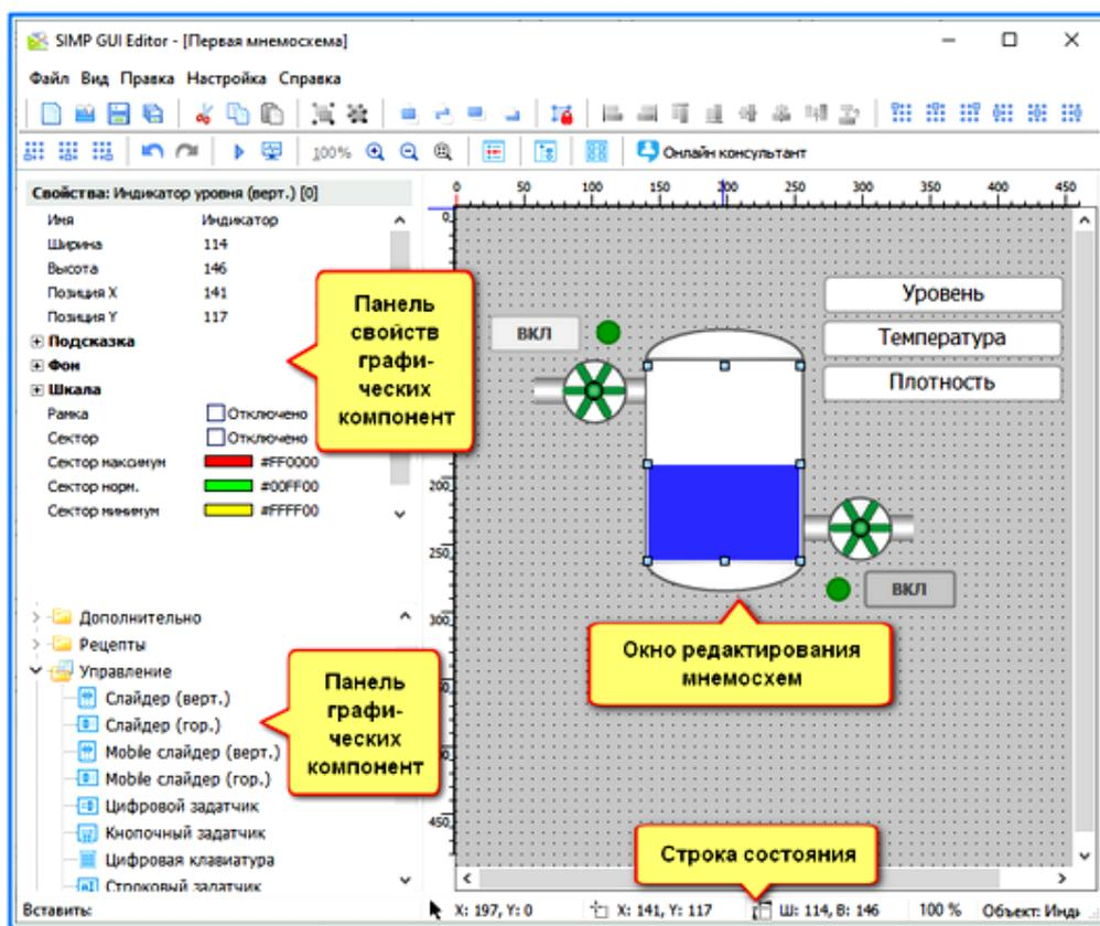
Рисунок 11. Окно редактора мнемосхемы после вставки некоторых элементов галереи и палитры
