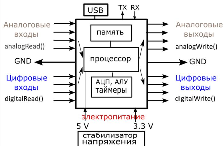
Рисунок 3. Схематический интерфейс платы содержащей микроконтроллер
