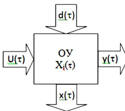
$X_i(\tau)$  – параметры состояния,  $x(\tau)$  – параметры состояния фиксируемые экспериментатором,  $U(\tau)$  – управляющие параметры,  $y(\tau)$  – управляемые параметры,  $d(\tau)$  – возмущающие воздействия.
