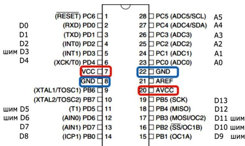
Рисунок 4. Расположение входов и выходов GPIO МК Atmega328
